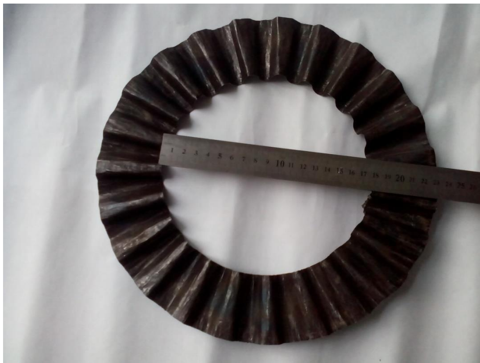
Рисунок 25 – Кольцевая гофрированная полоса с внутренним диаметром 180 мм
