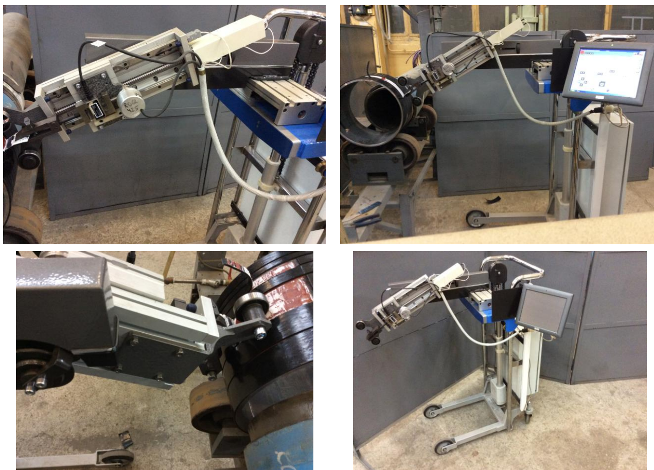
Рисунок 2.7 – Устройство определения прочности сцепления покрытия на трубе
