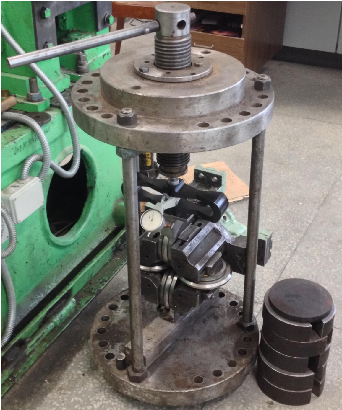
Рисунок 3.7 – экспериментальная установка (нагрузка с помощью винтового пресса)
