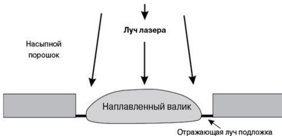
Рисунок 14 – Схема нанесения покрытий оплавлением предварительно нанесенного порошка
