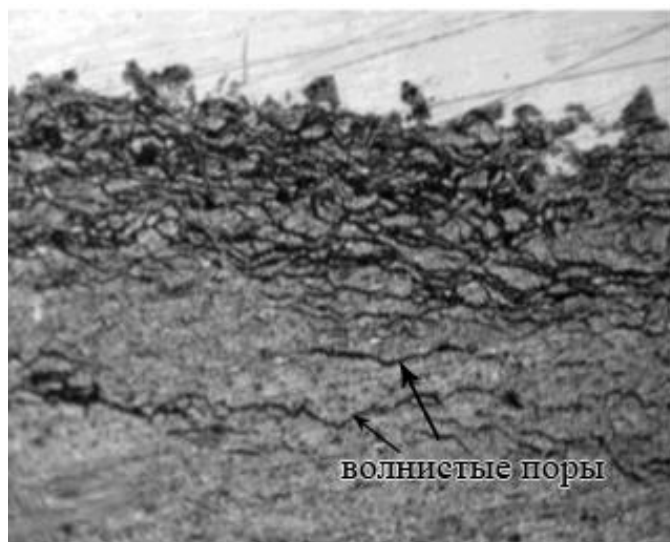
Рисунок 32 – Поперечное сечение покрытия, полученное при температуре потока 200 °С и расстоянии 5 мм.
