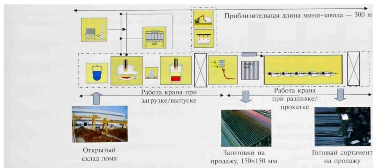
Рисунок 7 – Типовая схема мини-завода WinLink
