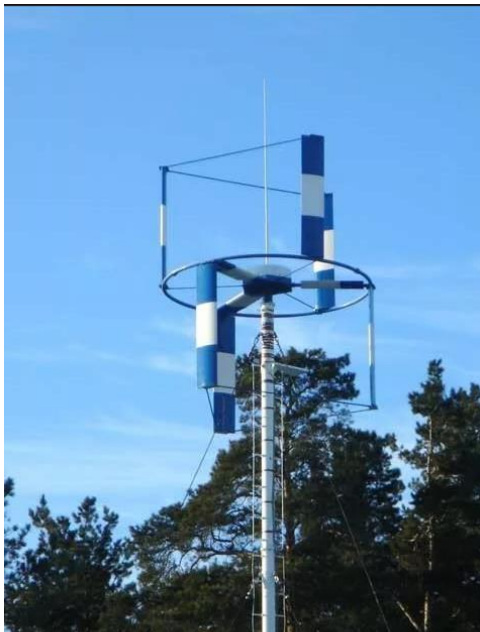
Рис.3 – Ветроустановка с вертикальной осью вращения.
