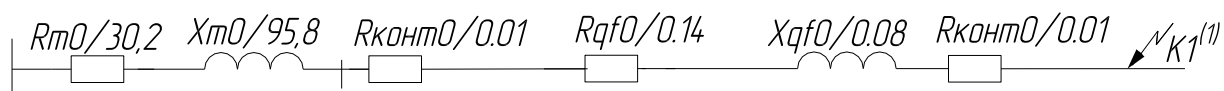
Рисунок М.1 – Схема замещения для расчета однофазного тока короткого замыкания для точек К1
