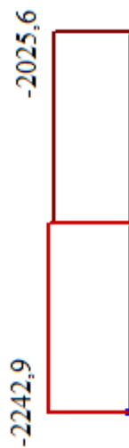
Рис. 3.14. Полная нагрузка. Эпюра продольных усилий N.
