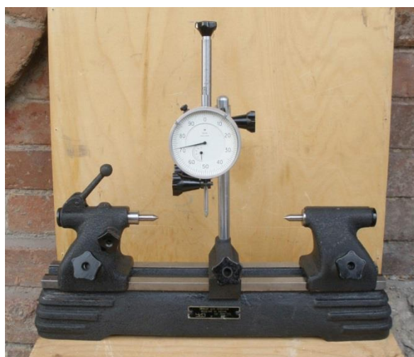
Рисунок 36 – Штатив с индикатором часового типа
