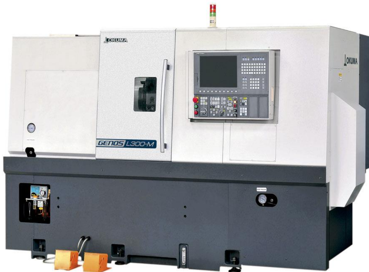
Рисунок 3 – Токарный обрабатывающий центр Okuma Genos L300E-MY
