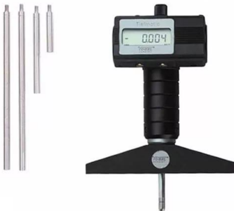
Рисунок 32 – Глубиномер ГМ-50-1 ГОСТ 7470-92
