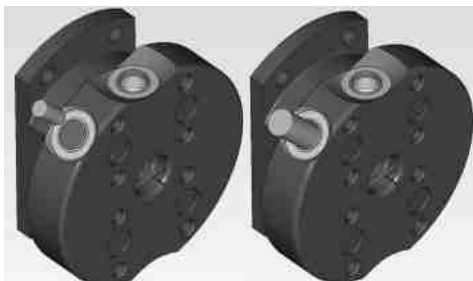
Рисунок 34 – Фрезерование контуров канавки
