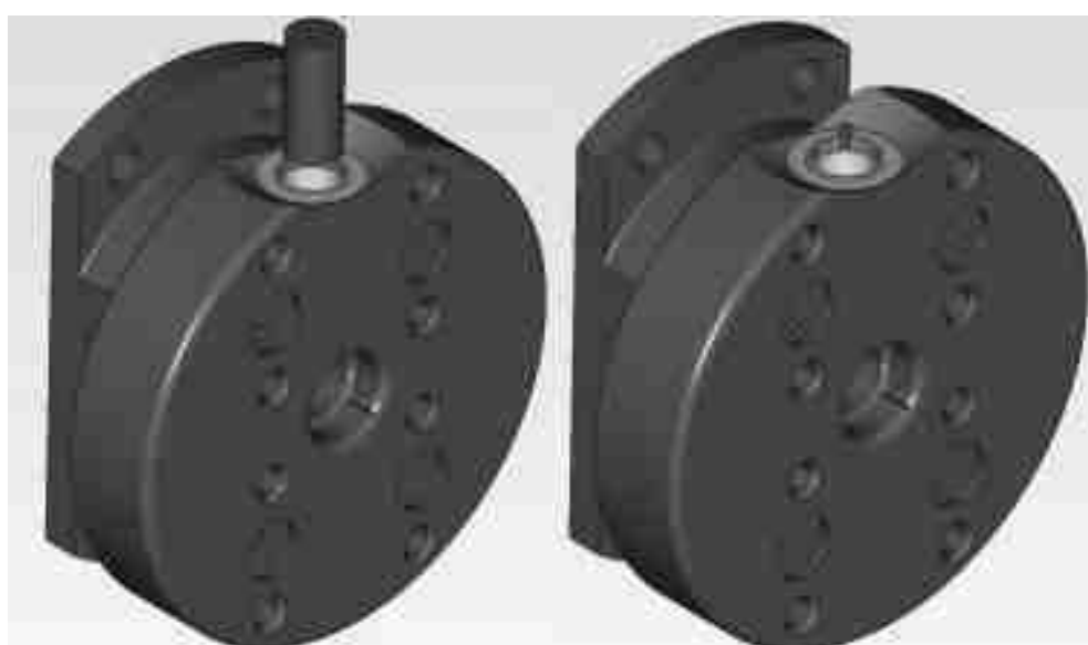
Рисунок 32 – Последовательное фрезерование контуров канавки и сверление отверстия
