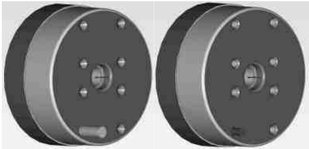
Рисунок 24 – Сверление отверстий и создание фасок
