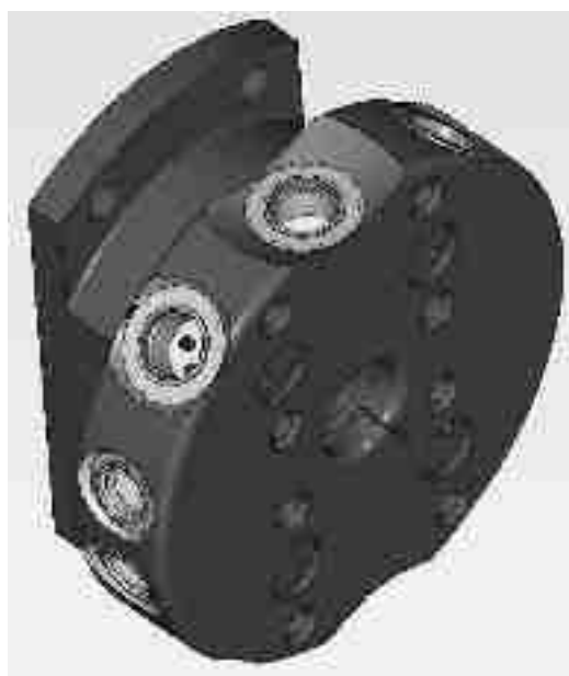
Рисунок 38– Вид заготовки после 010 операции
