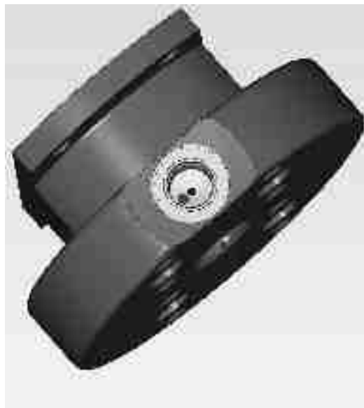
Рисунок 33 – Заключительное сверление отверстий и окончательный вид канавки и отверстий после переходов
