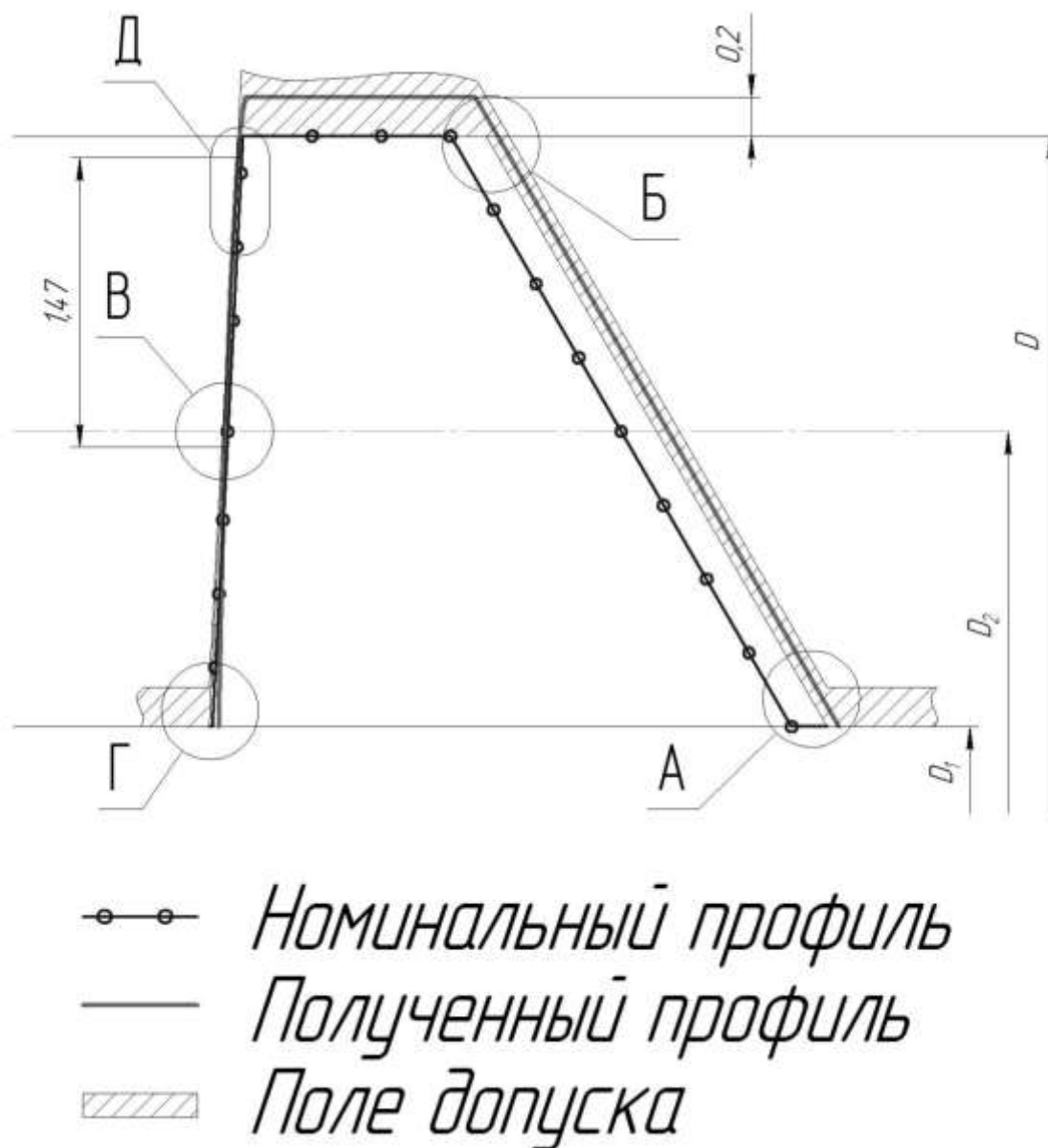
Рисунок 2.25 – Сравнение полученного профиля после увеличения межосевого расстояния и поля допуска на резьбу
