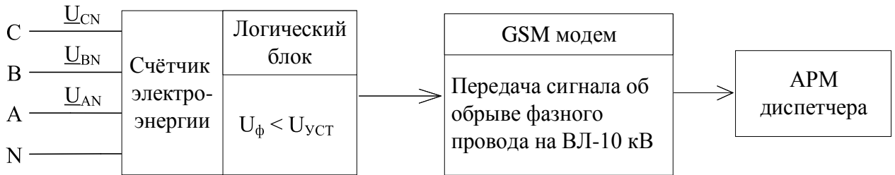
Рисунок 4.10 – Дополнительные функции микропроцессорного счётчика
