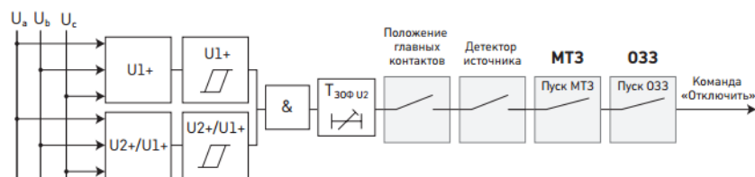
Рисунок 1.11 – Логика работы защиты от обрыва фазы по напряжению обратной последовательности
