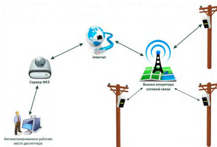
Рисунок 1.21 – Схема передачи данных для ИКЗ с GSM-модулем
