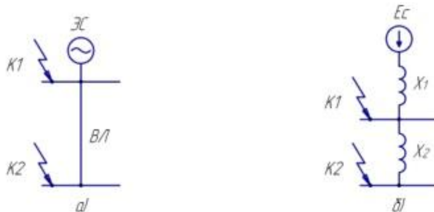
Рисунок 5.2 – Схемы для расчёта токов короткого замыкания: а) принципиальная схема; б) схема замещения
