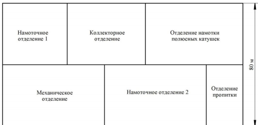
Рисунок 2.1 – План ремонтно-механического цеха
