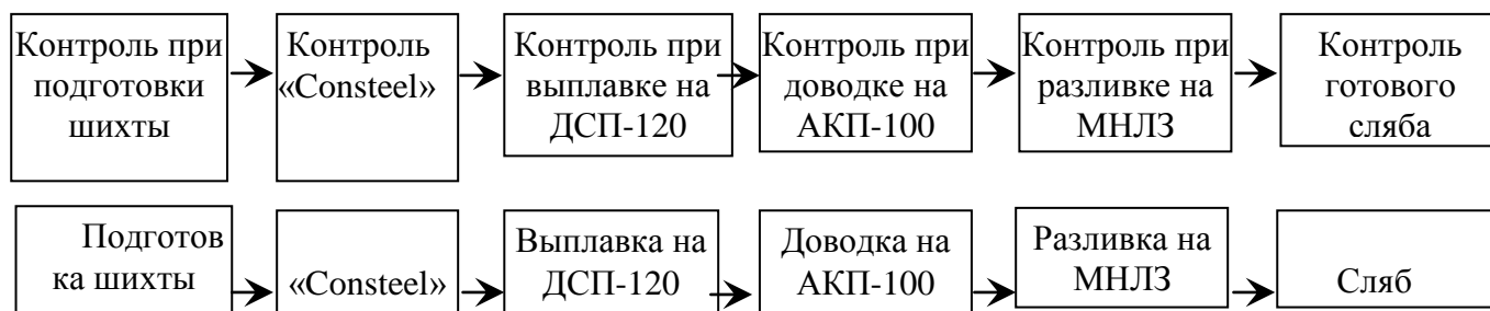
Рисунок 2 - Технологическая схема контроля качества продукции
