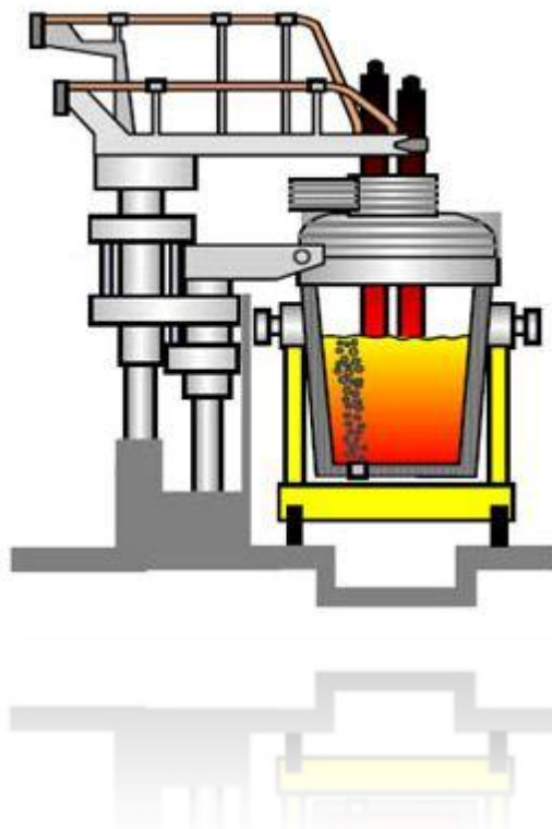
Рисунок 2 – Схема АКП-100 на ПАО «Ашинский метзавод»
