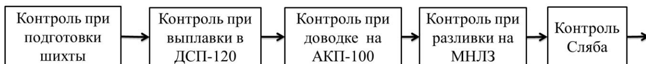
Рисунок 7 – Технологическая схема контроля при выплавке заготовки
