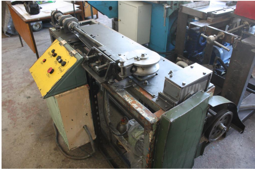
Рисунок 2.1 – Установка для гибки мелкокоротких труб с раскатыванием
