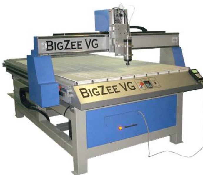
Рисунок 3.8 – Внешний вид станка с ЧПУ BigZee VG1318
