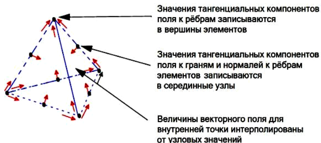
Рисунок 2.11 – Тетраэдрический 10-узловой конечный элемент
