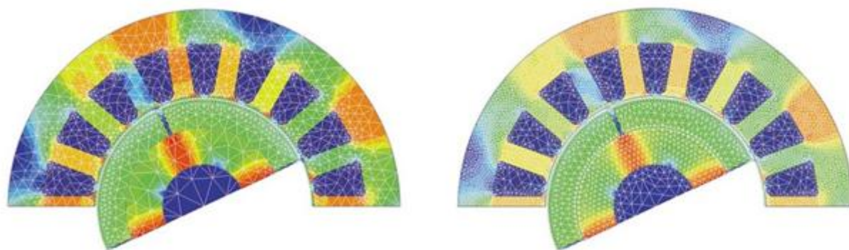
Рисунок 2.17 – Результаты расчета магнитного поля в электрической модели на начальной и усовершенствованной сеточной модели
