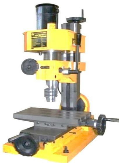
Рисунок 3.13 - Внешний вид фрезерного станка Энкор «Корвет-412»
