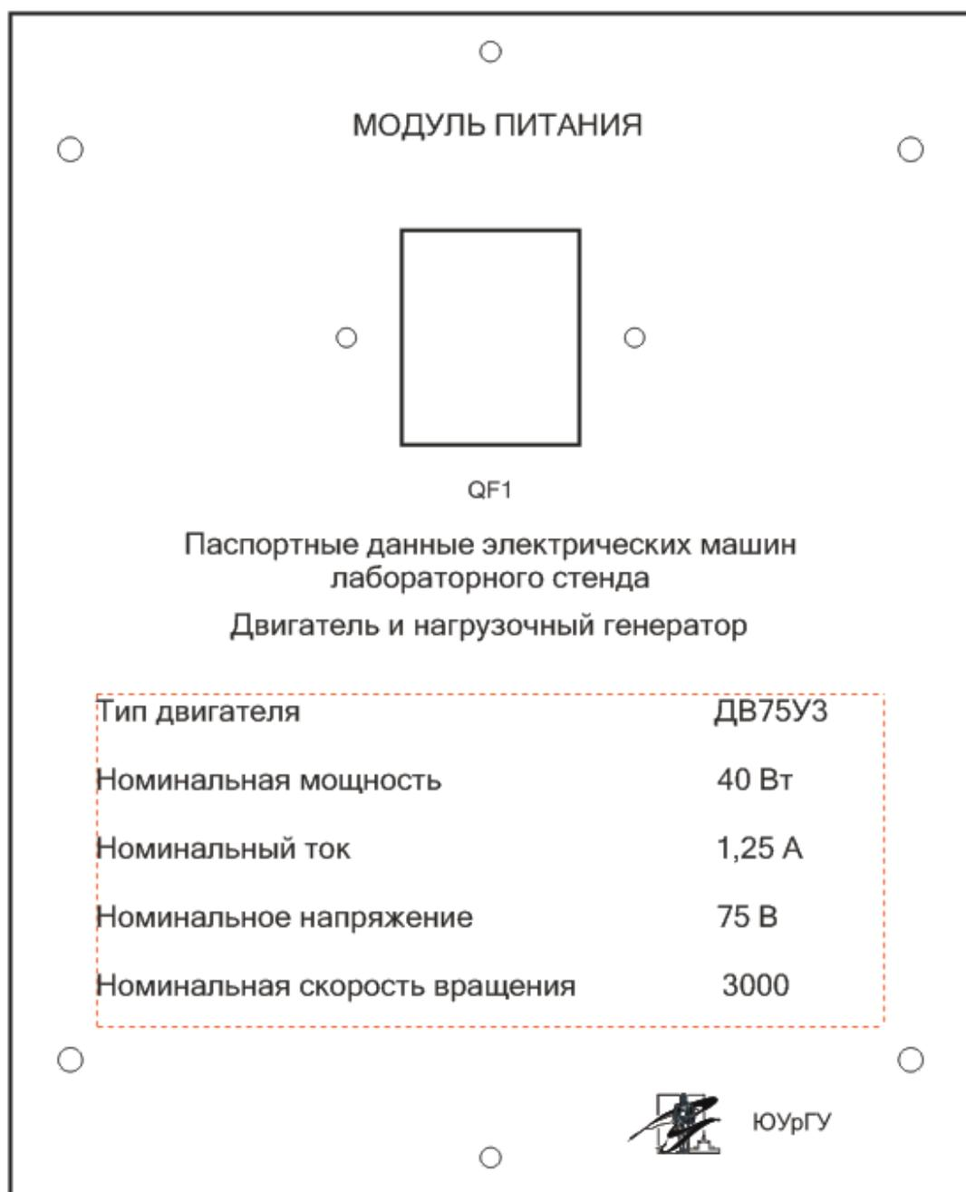
Рисунок 3.9 – Внешний вид панели модуля питания
