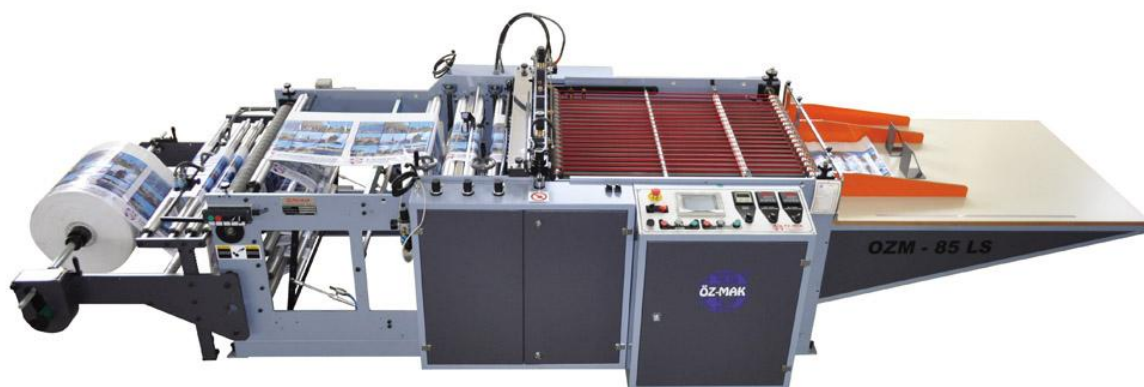
Рисунок 8 – OZM 100 LS универсальный станок для резки пакетов
