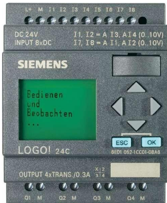
Рис. 4. Программируемое реле Siemens LOGO 6ED1052-1CC00-0BA6
