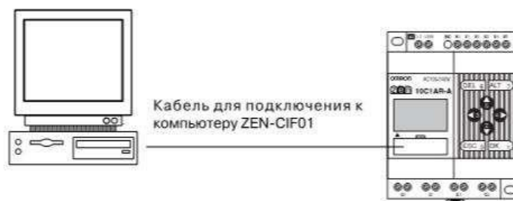
Рис.16. Подключение с помощью кабеля
