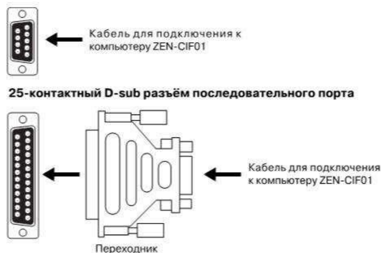
Рис.17. Разъем кабеля для подключения
