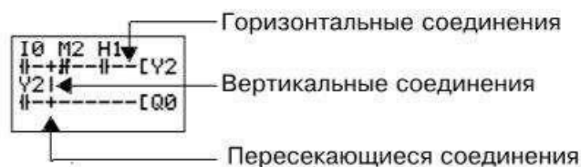
Рис.41. Ввод соединительных линий
