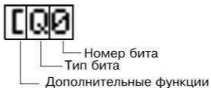
Рис.36. Структура обозначения выхода
