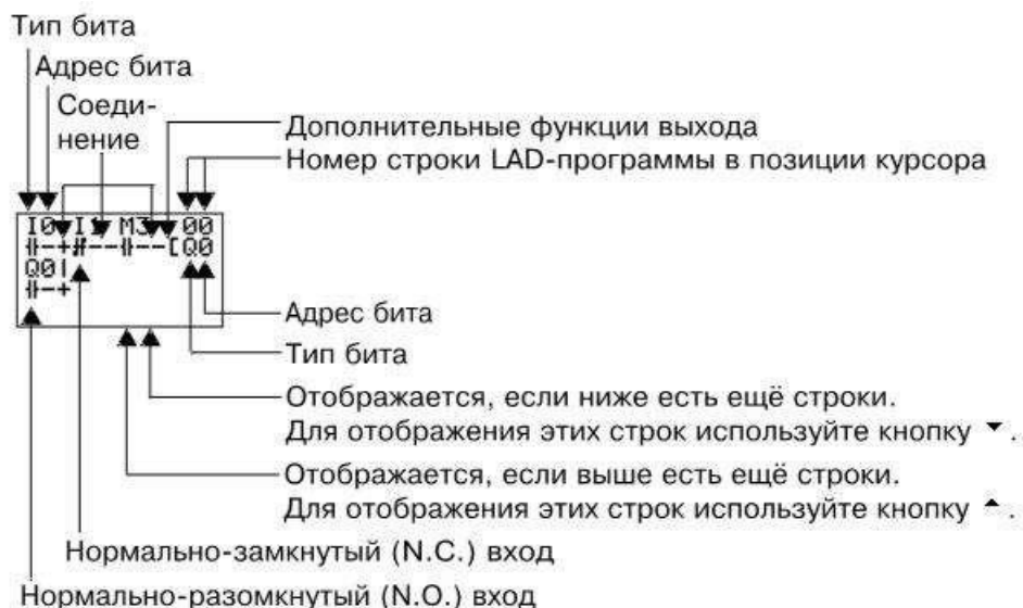
Рис.Х. Пример контактно-релейной схемы (LAD)
