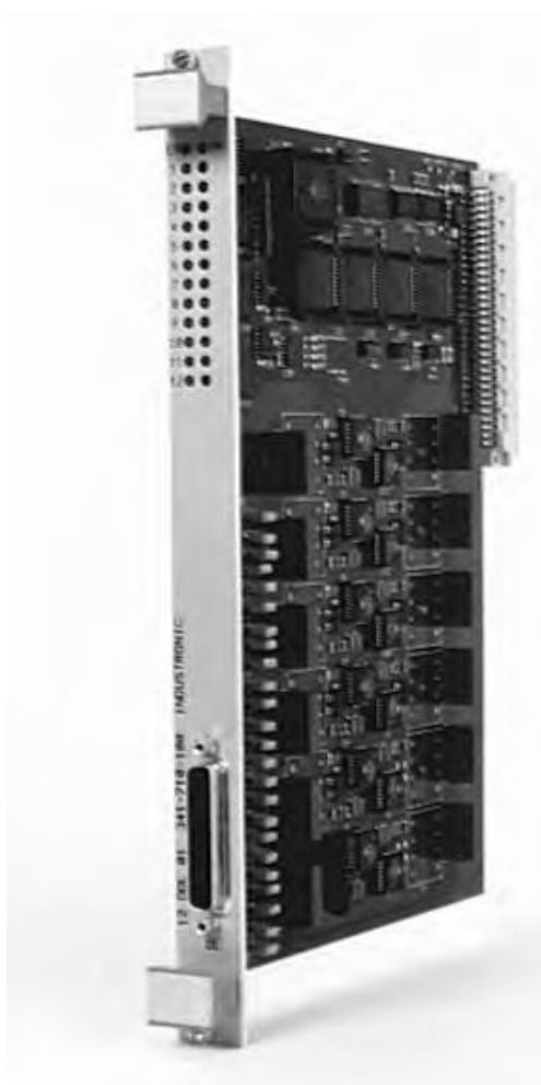
Рис. 8 Интерфейсный модуль для 12 цифровых абонентов 12 DDL 01 Механические характеристики:
