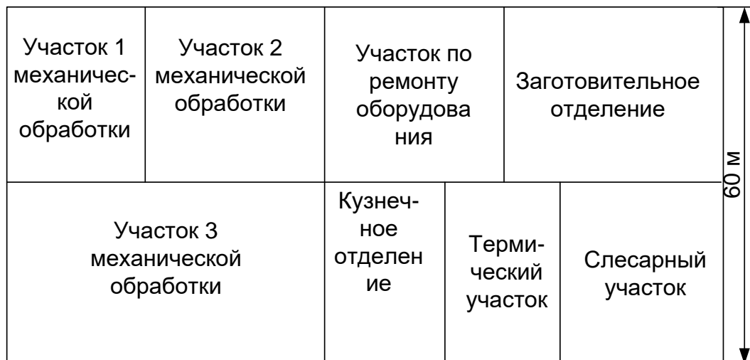
Рисунок 2.1 – План ремонтно-механического цеха
