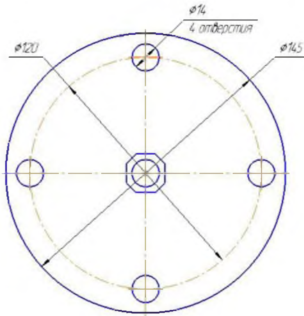
Рисунок 3.4 – Размеры присоединительного фланца
