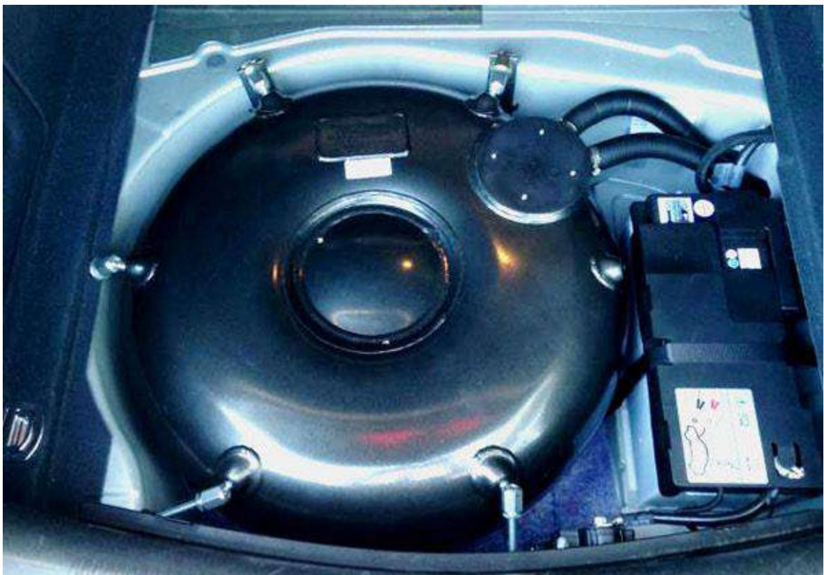
Рисунок 1.7 – Общий вид шестого поколения ГБО
