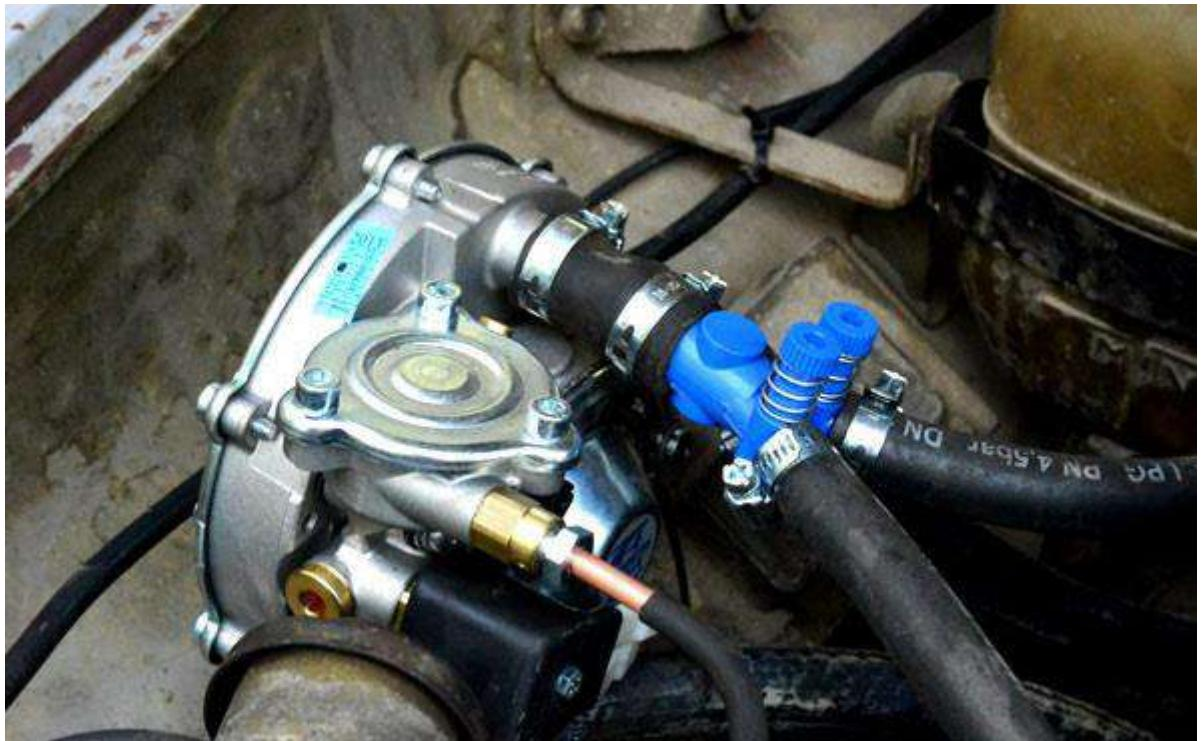
Рисунок 1.2 – Общий вид второго поколения ГБО
