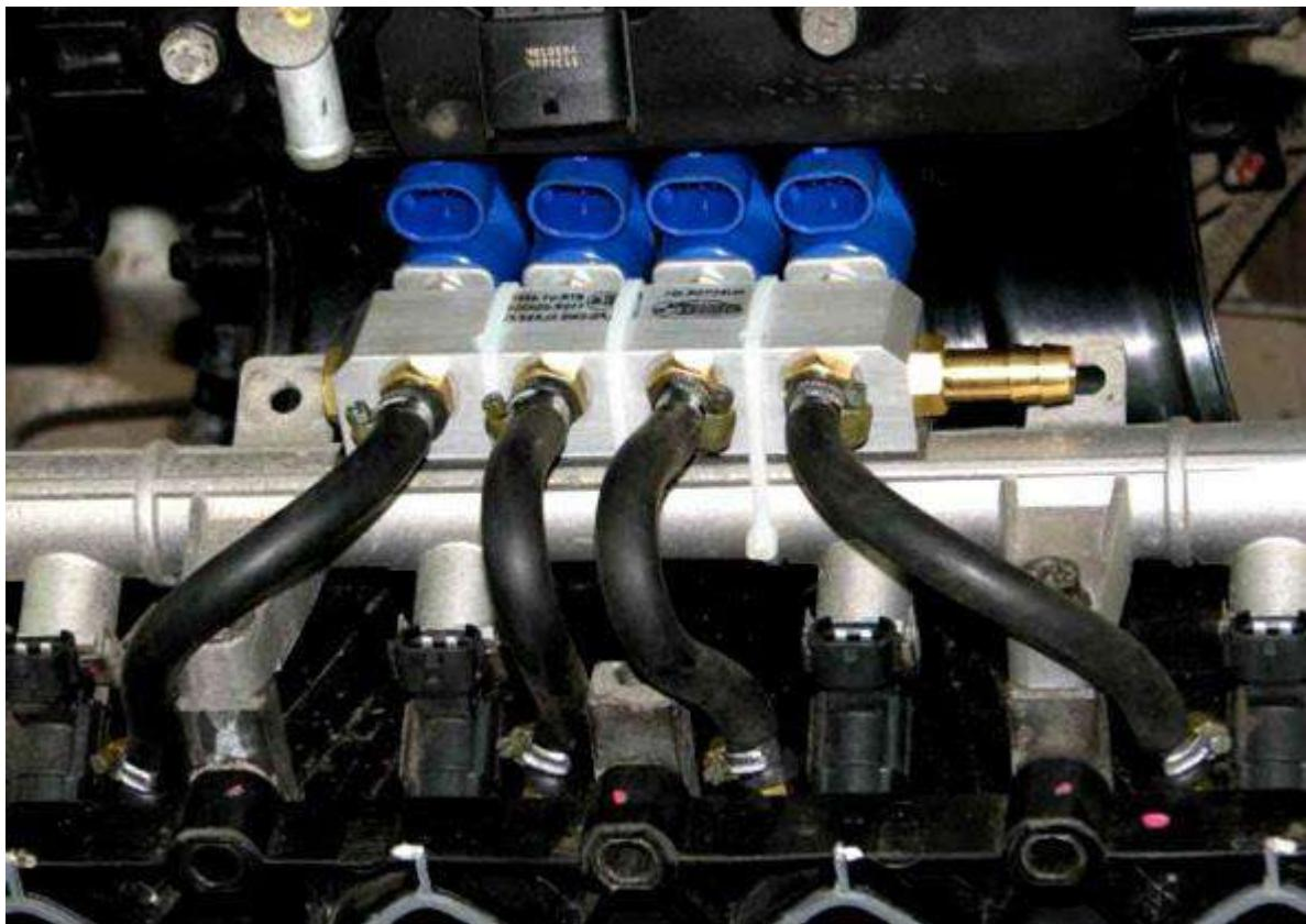
Рисунок 1.4 – Общий вид четвертого поколения ГБО
