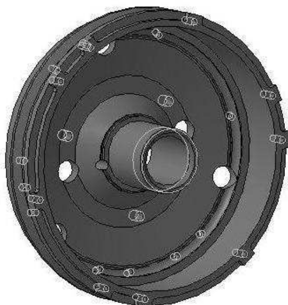
Рисунок 1.2 – 3D модель детали "Корпус опоры"
