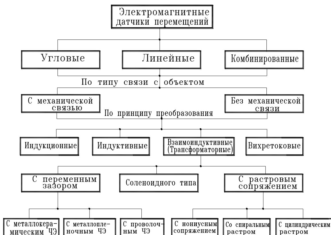
Рисунок 1.5 – Классификация электромагнитных преобразователей
