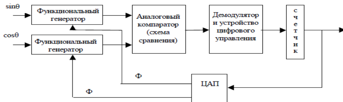
Рисунок 2.3 – Построение системы в виде замкнутого контура
