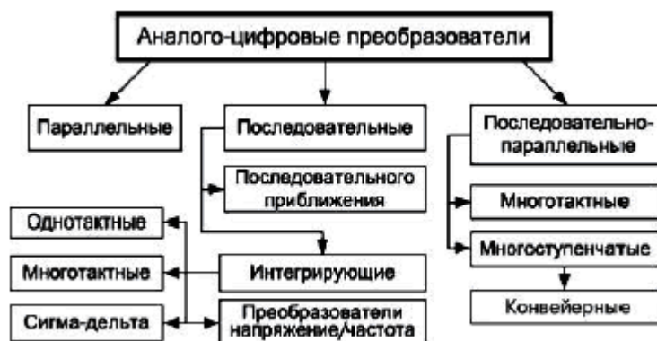
Рисунок 1.6 – Классификация АЦП по методам преобразования
