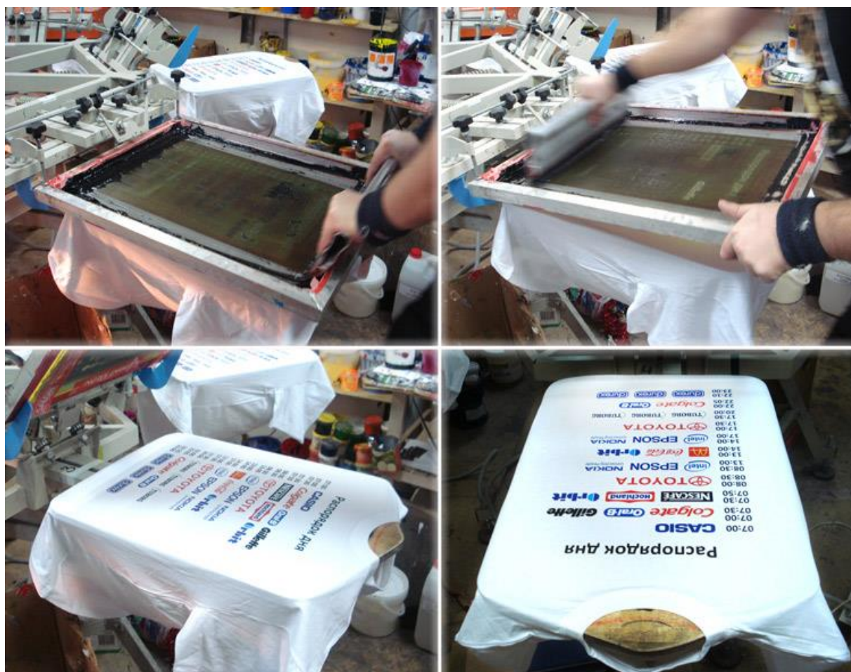
Рисунок 3.3 – Процесс нанесения изображения на текстильные изделия методом шелкографии
