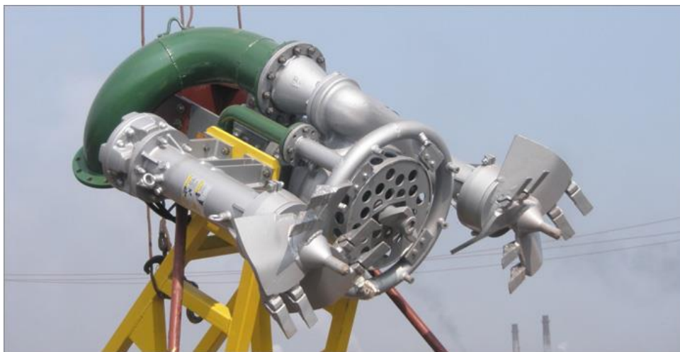
Рисунок 3.11 - Гидравлический погружной шламовый насос DRAGFLOW
