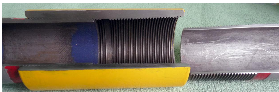
Рисунок 3.3 НКТ-73 с усиленной резьбой НКФ
