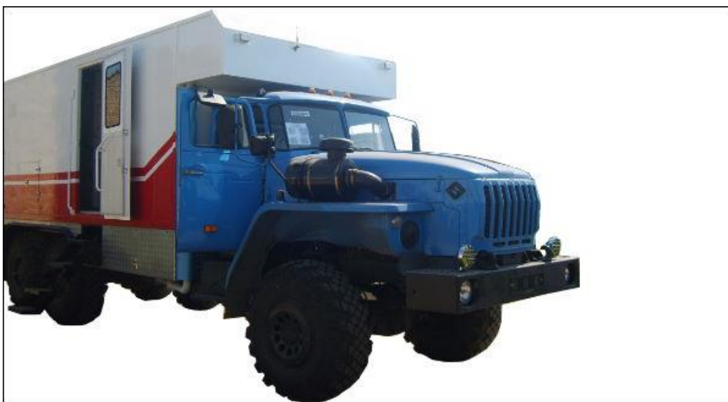
Рисунок 3.1 - Геофизический подъемник ПК-С-5-04
