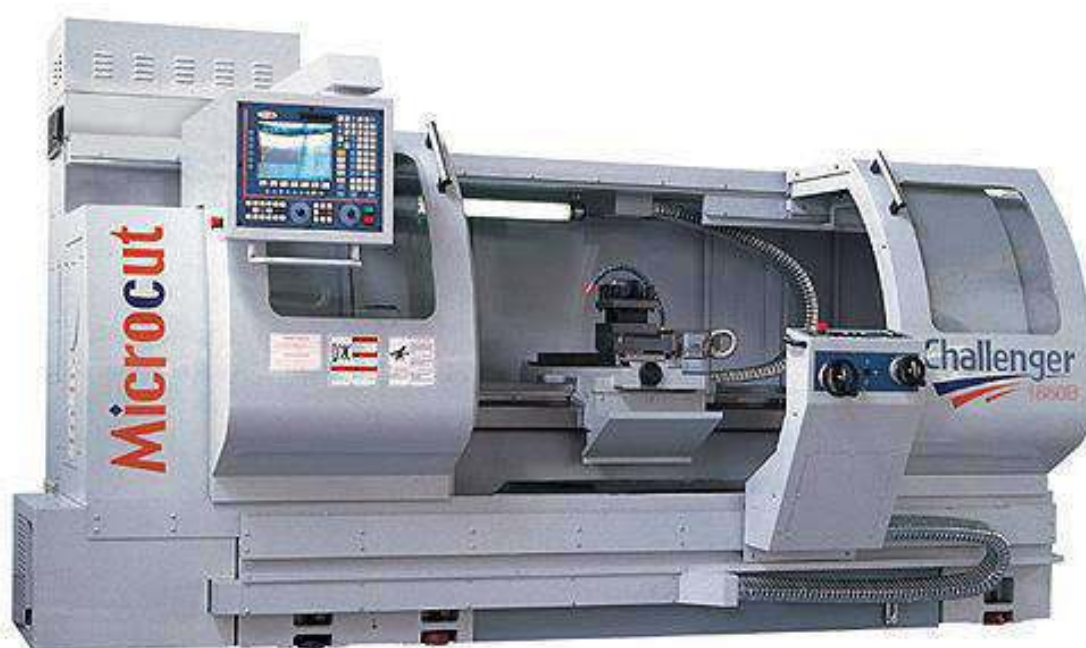
Рисунок 1.2 – Токарный станок с ЧПУ серии Microcut Challenger модели BNC-1840
