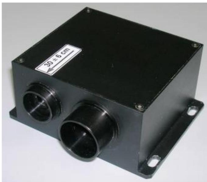
Рисунок 3.4 – Лазерный датчик скорости ИСД-5
