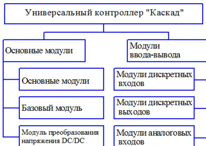
Рисунок 7.1 – Состав контроллер универсального «Каскад»
