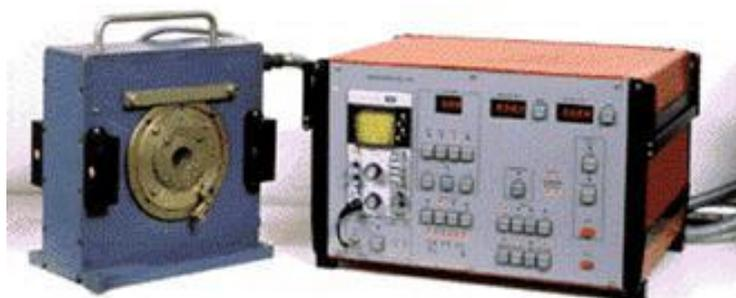
Рисунок 2.3 - Дефектоскоп ВД- 40П фирмы НПФ «Ультракон» (г. Киев)
