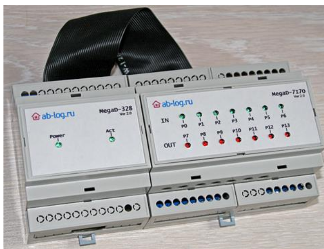
Рисунок 2.7 – MegaD-328 (слева) с исполнительным модулем MegaD-I7O7 (7 входов, 7 выходов)
