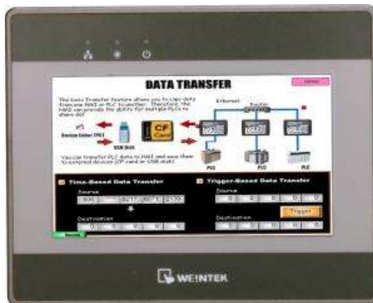
Рисунок 4.3 – Внешний вид панели Weintek MT6100i
