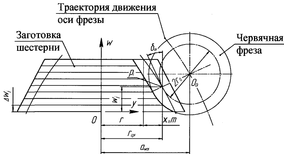
Рис. 2. Станочное зацепление заготовки незвольвентной шестерни и червячной фрезы
