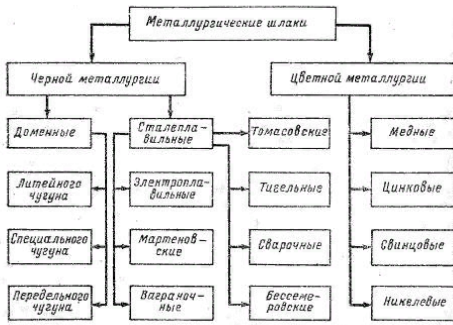
Рис. 1. Классификация металлургических шлаков
