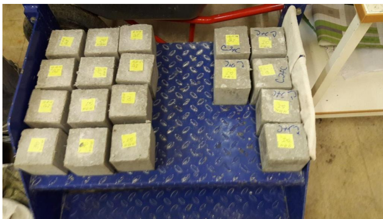
Рисунок 7 – Образцы-кубы. Отобранные для контроля показателей качества бетона
