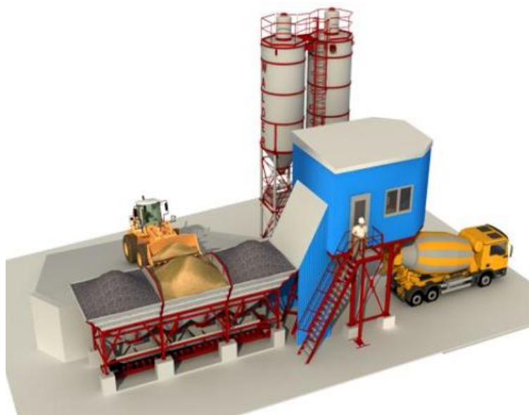
Рисунок 3 – Бетоносмесительная установка и загружаемый бетонной смесью автобетоносмеситель
