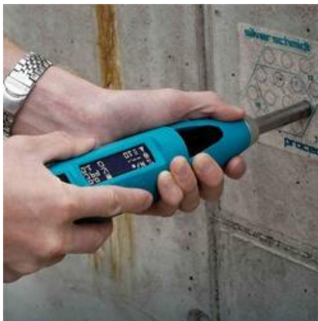
Рисунок 11 – Измерение прочности бетона методом упругого отскока с помощью электронного прибора Шмидта
