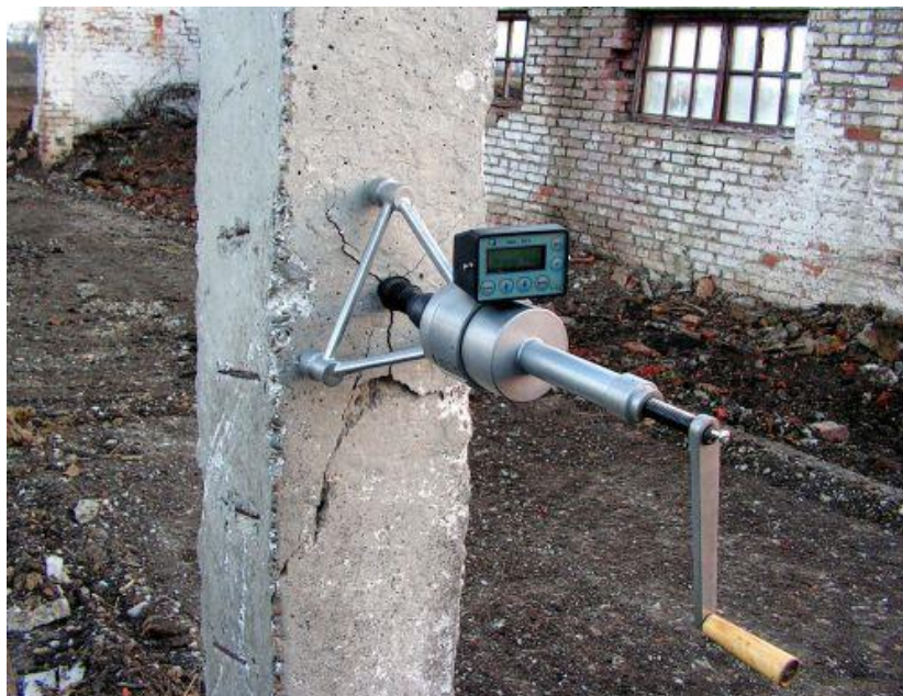
Рисунок 10 – Отрыв со скалыванием
