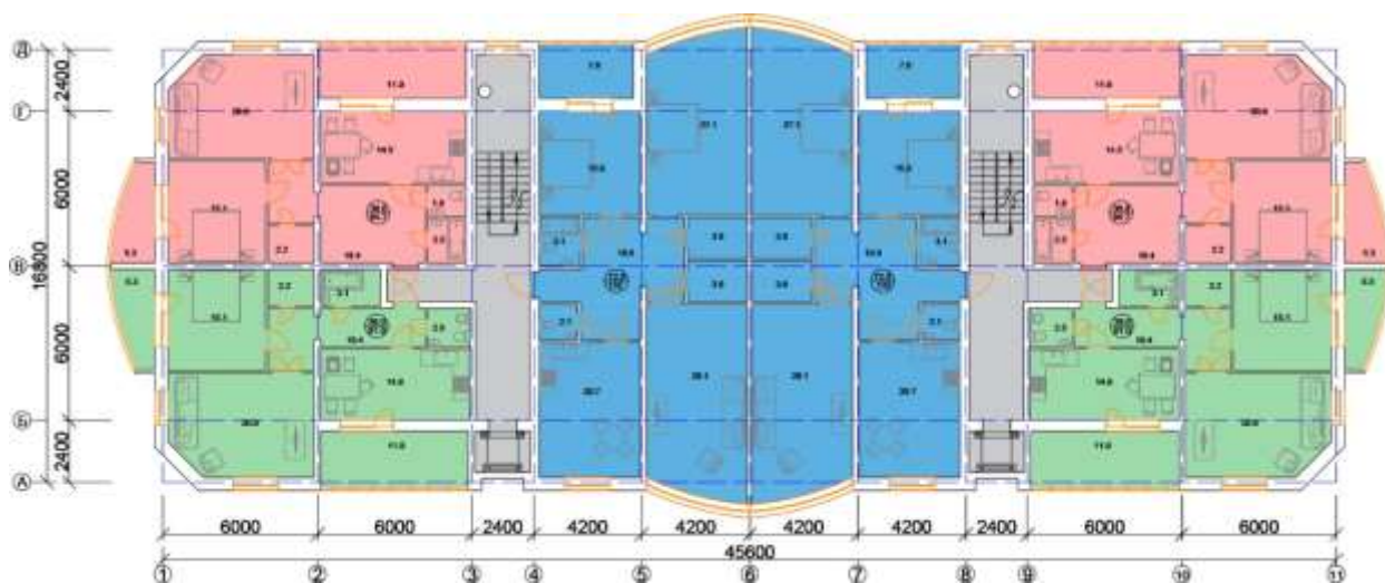
Рисунок 39 – План 6-9-го этажей 2-2-3-2-2-3. Первый вариант реконструкции серии 1-447
