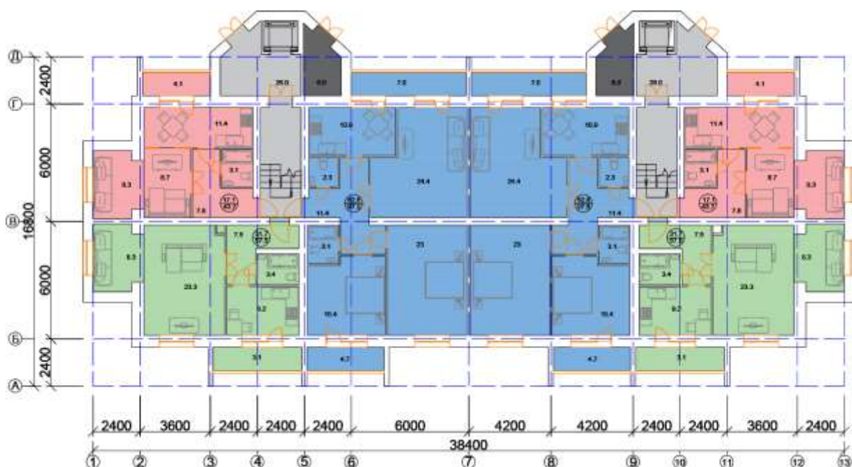
Рисунок 36 – План 1-го этажа 1-1-3-1-1-3. Второй вариант реконструкции серии 1-447
