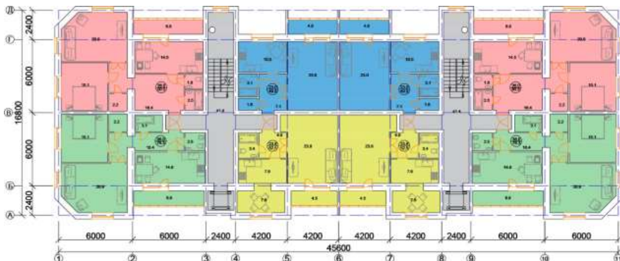
Рисунок 37 – План 2-5-го этажей 2-2-1-1-2-2-1-1. Первый вариант реконструкции серии 1-447
