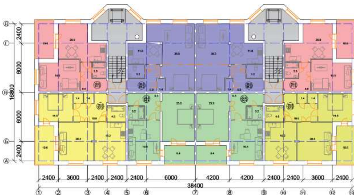
Рисунок 40 – План 6-9-го этажей 1-2-1-1-1-2-1-1. Второй вариант реконструкции серии 1-447
