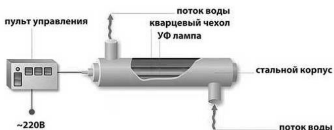
Рисунок 8 - Схема подключения ультрафиолетового фильтра для воды
