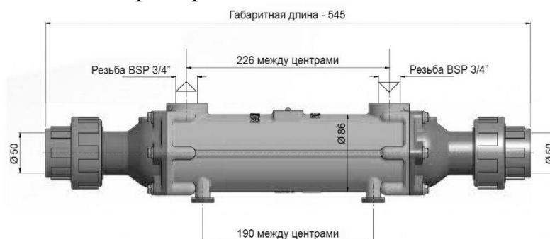
Рисунок 25 - Теплообменник «Bowman» 70,0 кВт
