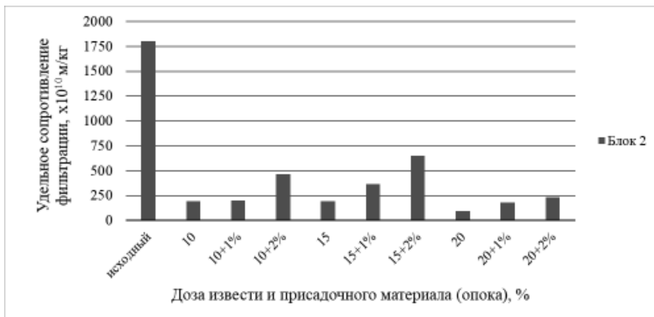
Рисунок 3.15 – Диаграмма зависимости величины удельного сопротивления фильтрации осадка ОСВ, отобранных в октябре 2017 года, от дозы вводимых реагентов
