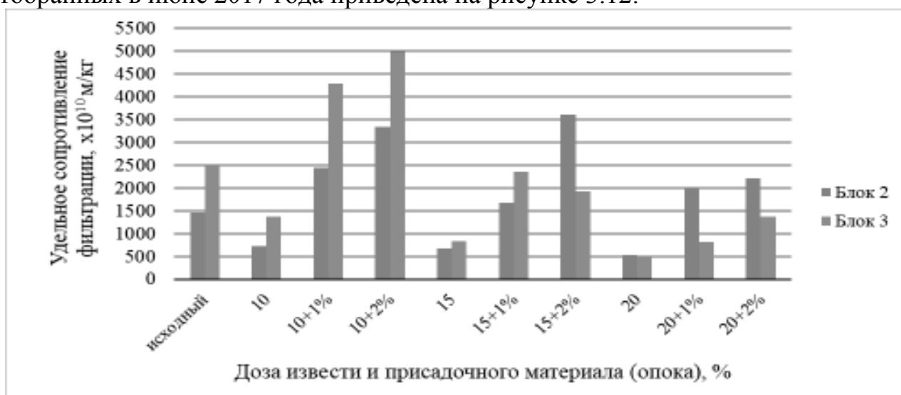
Рисунок 3.12 – Диаграмма зависимости величины удельного сопротивления фильтрации осадка ОСВ, отобранных в июне 2017 года, от дозы вводимых реагентов
