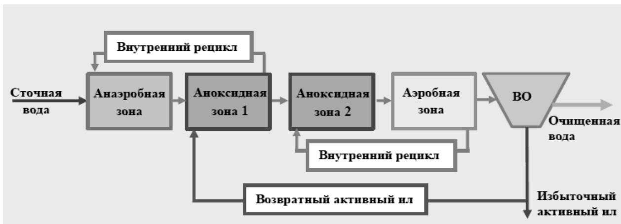
Рисунок 1.14 - Схема процесса МУСТ
