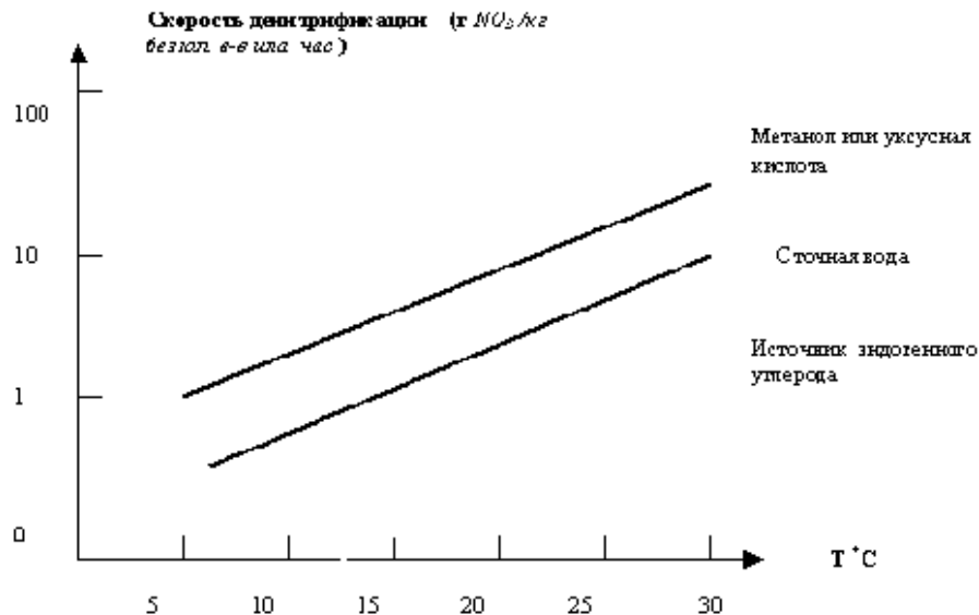
Рисунок 1.3 - Зависимость между температурой, источником субстрата и скоростью денитрификации
