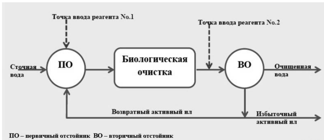
Рисунок 1.8 – Возможные точки ввода реагента
