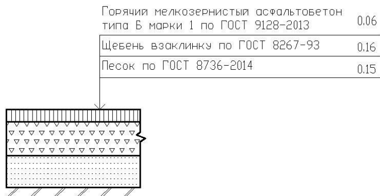
Рисунок 16 – Конструкция покрытия автопроезда
