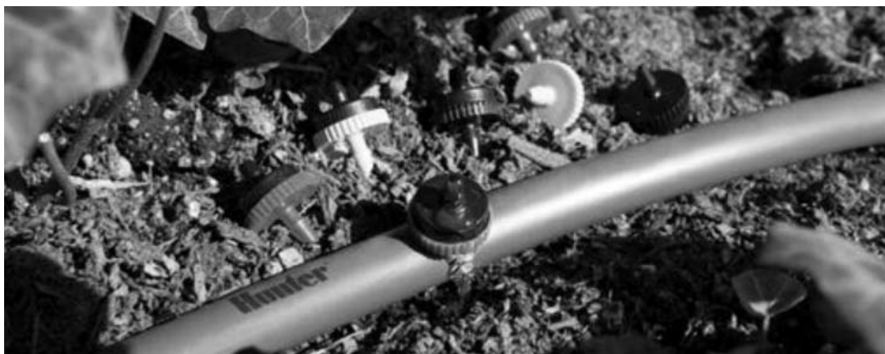
Рисунок 20 – Капельная трубка с установленной капельницей
