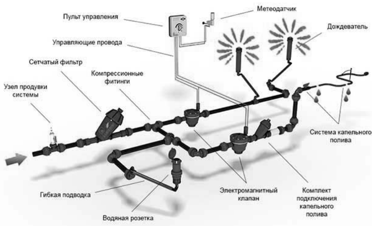
Рисунок 14 Схема устройства системы автоматического полива
