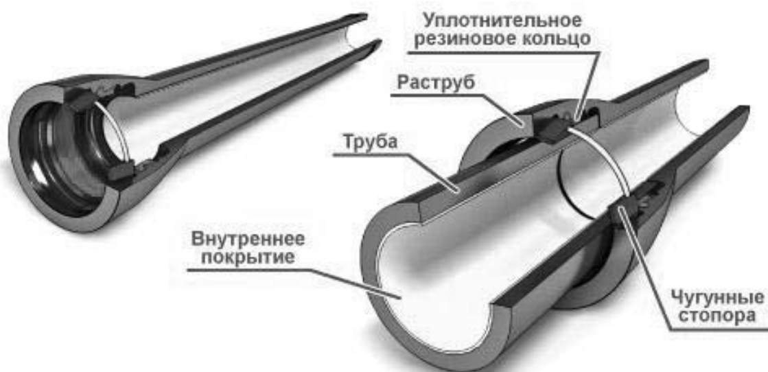
Рисунок 10 – Раструбное соединение труб
