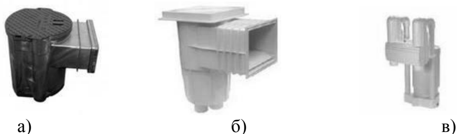
Рисунок 5 – Устройства для сбора воды с поверхности ванны бассейна а – скиммер встраиваемый из нержавеющей стали; б – скиммер встраиваемый из ПВХ; в – скиммер навесной из ПВХ
