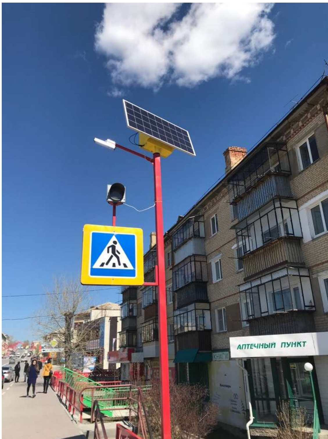
Рис. 2.10. Применение солнечных панелей для пешеходного перехода
